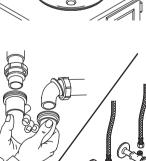
10. 连接进水管和落水。
