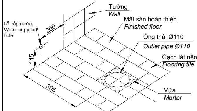
**Chú ý:** Trường hợp khi cắt gạch không làm kín khít xung quanh ống thải thì phải làm phẳng với vữa và cao bằng mặt sàn hoàn thiện. Vữa phải khô mới được tiến hành các bước tiếp theo.
