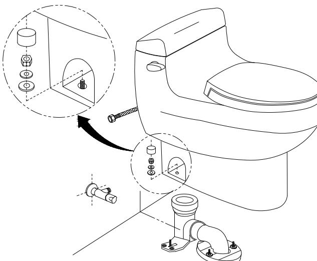
6. Lắp dây cấp với van dừng, cố định bàn cầu và làm kín chân bàn cầu bằng si-li-côn./ *Connect the flexible hose with the stop valve fixed the toilet then the close leg by silicone.*
