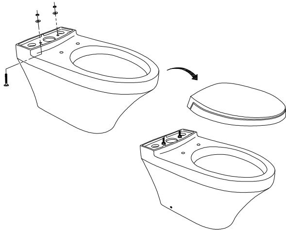
7. Lắp két nước vào thân cầu/ *Install the tank with the toilet body.*
