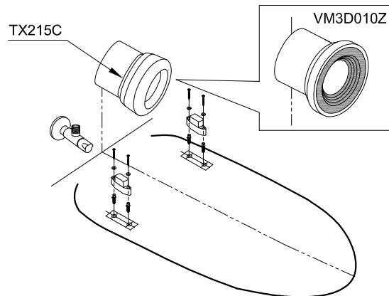
5. Lắp dây cáp nước vào van cấp.
