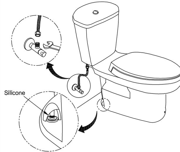
9. Làm kín chân bằng silicone./ *Close leg by silicone.*
