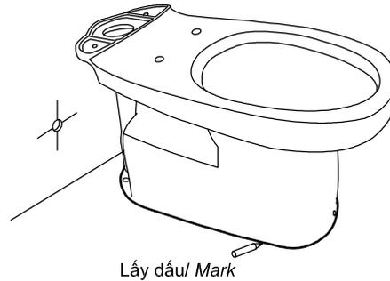
3. Khoan lỗ cố định bàn cầu và lắp van dừng./ *Drill the holes fixed the toilet then installation the stop valve.*
