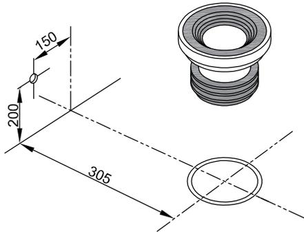
2. Đặt bàn cầu vào vị trí lắp đặt, lấy dấu lỗ cố định và chân./ *Place the toilet into installation position then mark fixed holes and toilet leg.*
