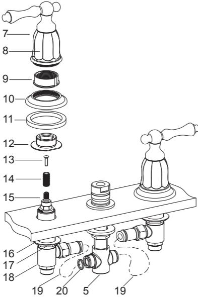
将垫片(20)放入软管(19)的两端。如图所示，将阀体(18)与T型接头(5)用软管连接。**注意：**软管(19)只能用在此处。
