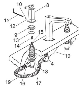
用垫片及软管(19)连接阀体和T型接头(4)。
