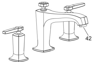
取下起泡器(42)。打开冷热水阀，使水流过出水口，除掉杂物，关闭阀。重新安装起泡器。
