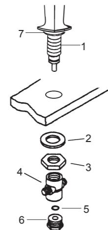
将出水口装于脸盆的中孔。
