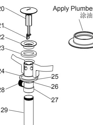
**注意：**如果需要可直接在法兰盘底面沿周围涂一圈密封油灰，而不使用垫片(23)。
