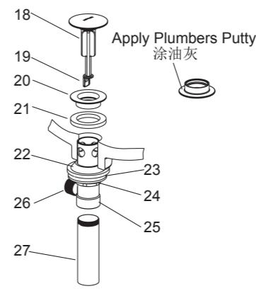
**注意：**如果需要，可直接在法兰盘底面沿周围涂一圈密封油灰，而不使用垫片(21)。
