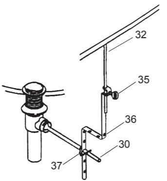
把尾管接上存水弯，尾管须插入存水弯25mm到50mm。
